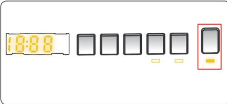
Durch Drücken der Start/Pause-Taste können Sie ein ausgewähltes Programm starten oder ein bereits laufendes Programm anhalten. Falls Sie Ihre Maschine in den Bereitschaftsmodus schalten, blinkt die Start/Pause-LED am Display.
