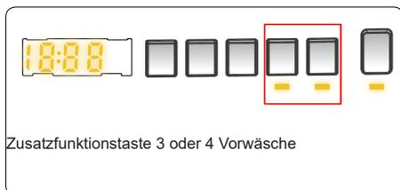
Bei dieser Zusatzfunktion erhält stark verschmutzte Wäsche eine Vorwäsche vor dem Hauptwaschgang. Bei Verwendung dieser Funktion geben Sie Waschmittel in das vorderste Waschmittelfach der Waschmittelschublade.
