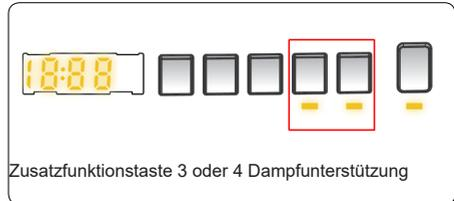
Zusatzfunktionstaste 3 oder 4 Dampfunterstützung
