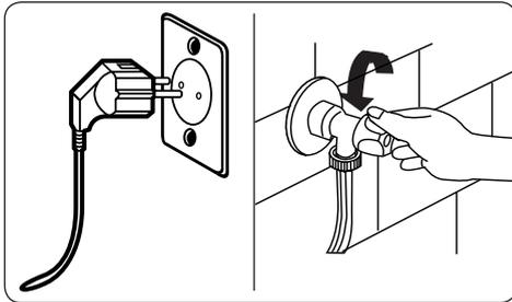
Schalten Sie Ihre Maschine aus und ziehen Sie den Netzstecker aus der Steckdose, bevor Sie Reinigungs- oder Wartungsarbeiten an ihr vornehmen.
