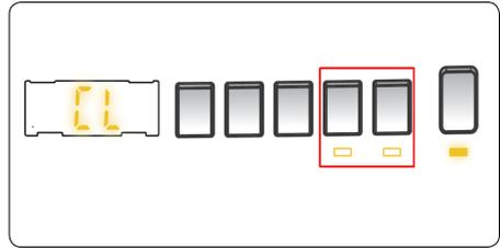
Wenn bei aktiver Kindersicherung eine Taste gedrückt oder das ausgewählte Programm über den Programmknopf geändert wird, blinkt das „CL“-Symbol 2 Sekunden lang am elektronischen Display.
