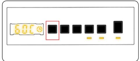
Wenn Sie ein Programm wählen, wird automatisch die maximale Temperatur für dieses Programm ausgewählt. Passen Sie die Temperatur an, indem Sie die Wassertemperatur-Einstelltaste drücken, bis die gewünschte Temperatur am Digitaldisplay angezeigt wird.
