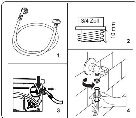
1. Ihre Maschine verfügt je nach Spezifikationen entweder über einen einzelnen Wasserzulauf (Kaltwasser) oder einen doppelten Wasserzulauf (Warm- und Kaltwasser). Der Schlauch mit weißer Kappe darf nur an einem Kaltwasserzulauf, der Schlauch mit roter Kappe kann an einem Warmwasserzulauf angeschlossen werden (falls zutreffend).
