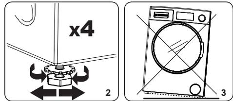
2. Drehen Sie die FüÙe zum Anheben der Maschine im Uhrzeigersinn. Drehen Sie die FüÙe zum Absenken der Maschine gegen den Uhrzeigersinn.
